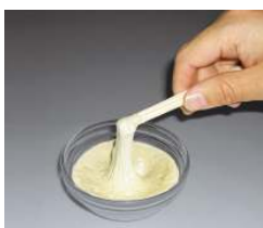
高層ビルの制震装置に 用いられる粘弾性体
